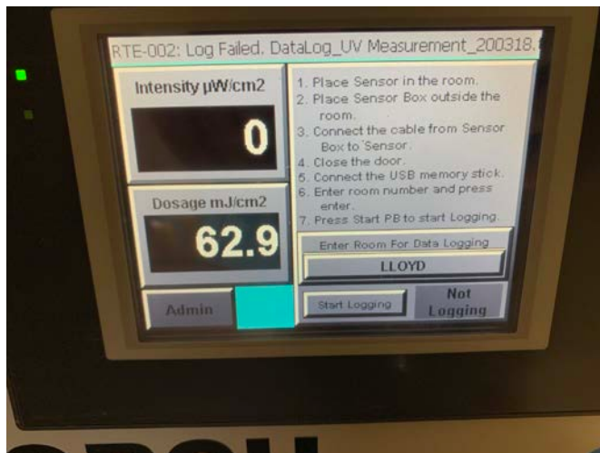
Figura 14 –Deja correr el ciclo de irradiación hasta que la dosis sea por lo menos de 300 mJ/cm 2 .
